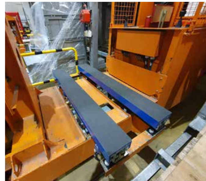
Manuelles RBG mit Teleskopgabel 1to
