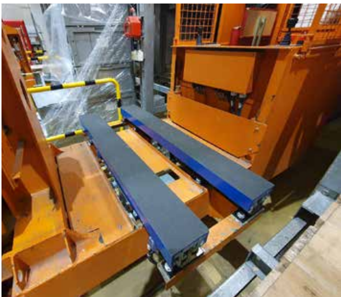
Manuelles RBG mit Teleskopgabel 1to
