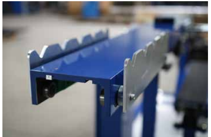
Teleskopgabel zur Aufnahme von Rundmaterial
